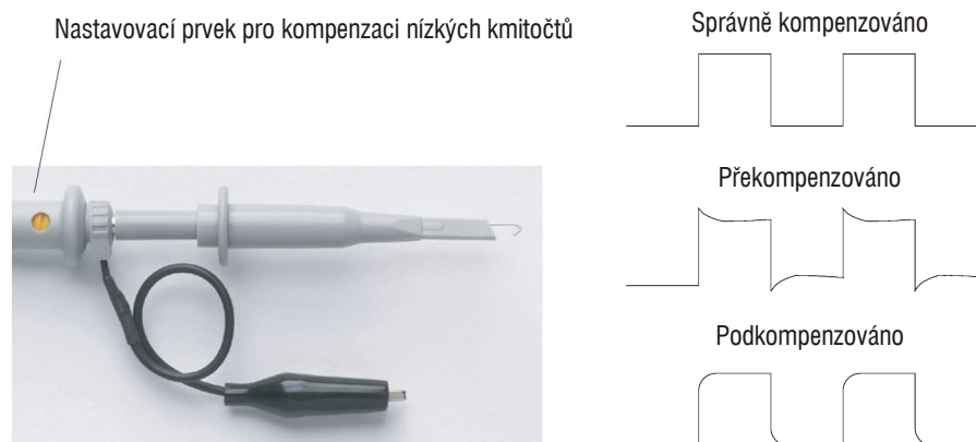
Obrázek 4 Kompenzace sondy pro nízké kmitočty
