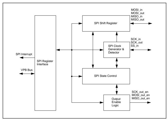
Figure 37: SPI Block Diagram
