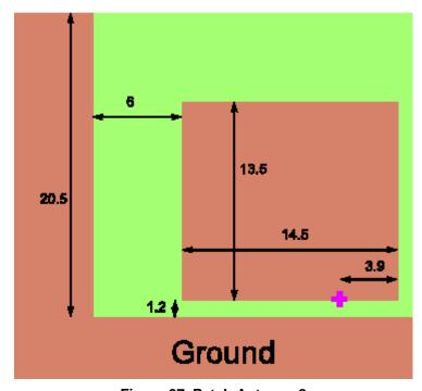
Figure 27. Patch Antenna 2
