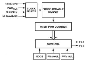
Figure 26. PWM Block Diagram
