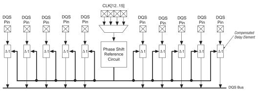
Figure 67. Phase Shift Reference Circuit Control of DQS Delay
