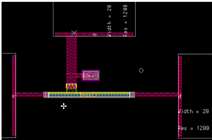
Obr. 26 – Výsledok DRC po pripojení záťaže k tranzistoru
